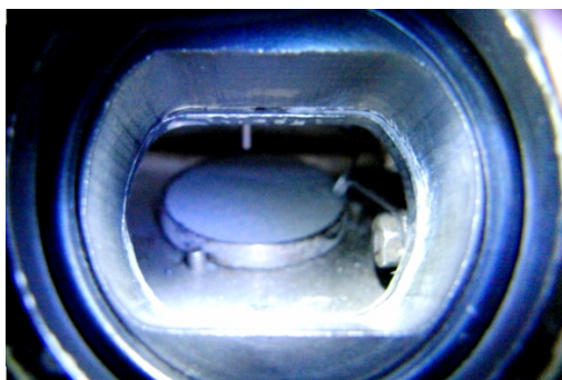
Рис. 6. Взаимное расположение дискового образца, поджигающего элемента (на правой границе образца), овального канала видео-регистрации (по центру) и оптического канала пирометра (трубка над образцом)
